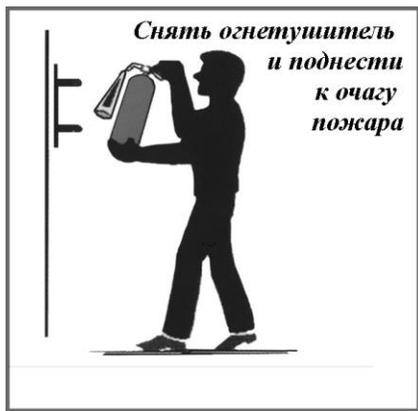
Основан на вытеснении двуокиси углерода избыточным давлением. При открывании запорнопускового устройства CO<sub>2</sub> по сифонной трубке поступает к раструбу и из сжиженного состояния переходит в твердое (снегообразное). Температура резко до -70 гр.С. понижается. Углекислота, попадая на горящее вещество, изолирует его от кислорода и охлаждает
