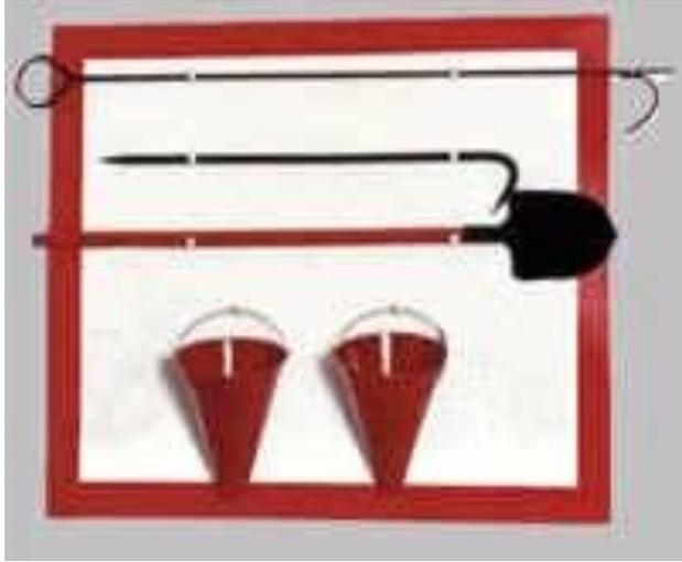
▶ **ИНСТРУМЕНТ ПОЖАРНЫЙ РУЧНОЙ** немеханизированный инструмент без какого-либо привода, предназначенный для выполнения различных работ при тушении пожара (пожарные багры, ломы, топоры, крюки).
